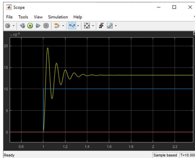
Como puedes comprobar, la salida del sistema se parece mucho a la de un sistema de segundo orden puro subamortiguado, sin ceros:
