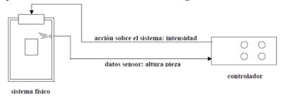
El funcionamiento de este montaje se puede explicar fácilmente: al controlador se le fija una altura de referencia para la pieza, con lo cual su objetivo será lograr que la altura real esté lo más próxima a esa
