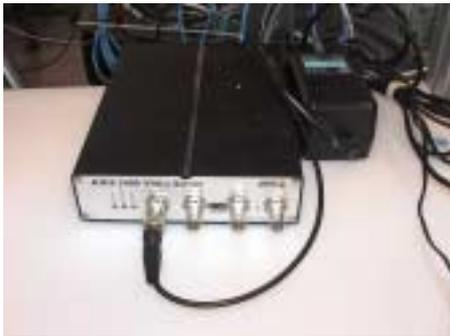
Figura 3: Servidor de video Axis 2400
