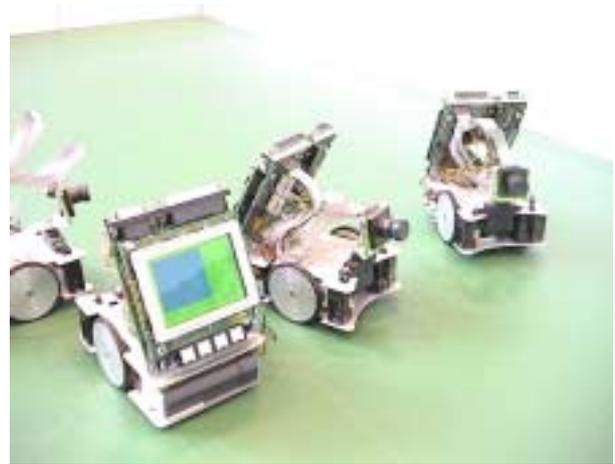
Figura 6: Robots móviles Eyebot
