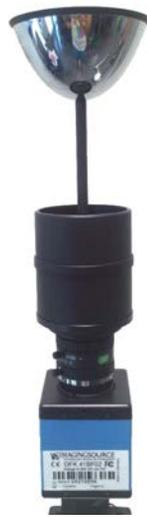
Figura 2: Sistema real de adquisición de imágenes omnidireccionales.
