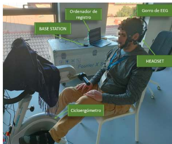
Figura 2: Montaje de los experimentos realizados. Sujeto de pruebas realizando una de las sesiones de registro de señales EEG. Las señales se capturan mientras pedalea y ejecuta las tareas mentales. Se tapó la pantalla interactiva del cicloergómetro para evitar estímulos externos al protocolo de registro.
