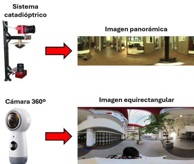
Figura 1: Sistemas de visión omnidireccional empleados en este trabajo: sistema catadióptrico (parte superior) y cámara 360° (parte inferior).
