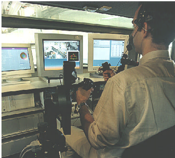
Figura 2. Estación de control e interfaz del operador
