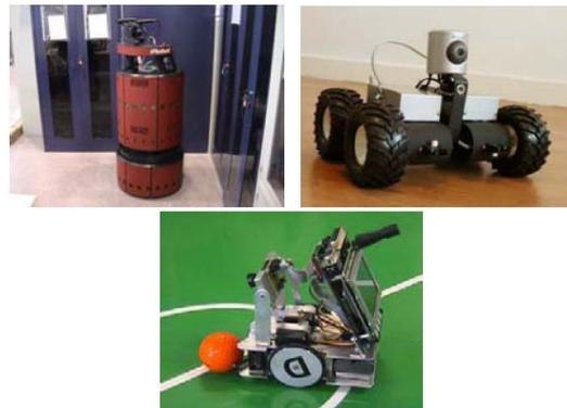
Fig. 1: Robots utilizados en la plataforma. B21r, WiFiBot y EyeBot.
