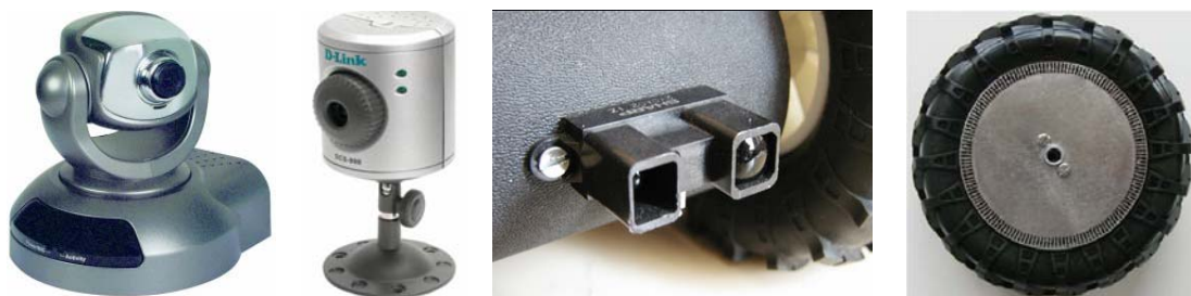
Figura 2: Sensores de WifiBot: a) Cámara MPEG-4 Pan/Tilt. b) Camara DCS-900. c) Sensores de infrarrojos. d) Encoder.
